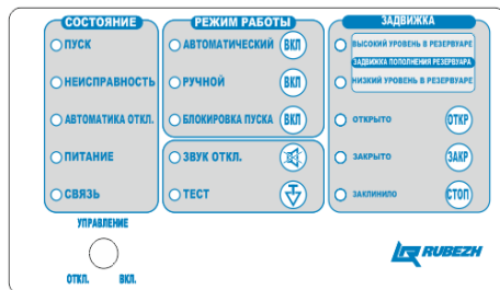
Рисунок 16 – а) ШУЗ без индикации состояния датчиков уровня резервуара; б) ШУЗ с индикацией состояния датчиков уровня резервуара
